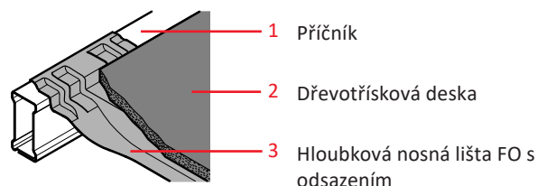
Obr. 20 Dřevotřísková deska jako dno buňky, uložená na hloubkové nosné liště s odsazením FO
